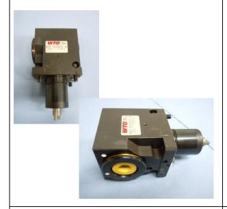
Angetriebenes Werkzeug abgewinkelt
