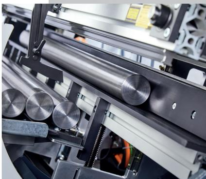
Durchgängig ausgeführte „V-Rinne“ zur effizienten Zuführung auch von kurzen Stangenabschnitten.
