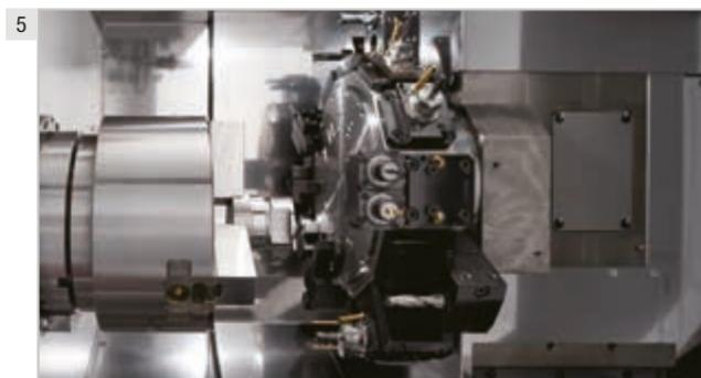
1 Simultanbearbeitung rechts/links für kürzere Prozesszeiten: Aufgrund der simultanen Bearbeitung mit der linken und rechten Spindel können Revolver-Werkzeughalter und Hauptspindel die Bearbeitung durchführen, gefolgt von der Abgreifspindel, die anschließend für die Überlappungsbearbeitung und ähnliche Prozesse zuständig ist. Die Folge ist eine weitere Reduzierung der Bearbeitungszeiten.
