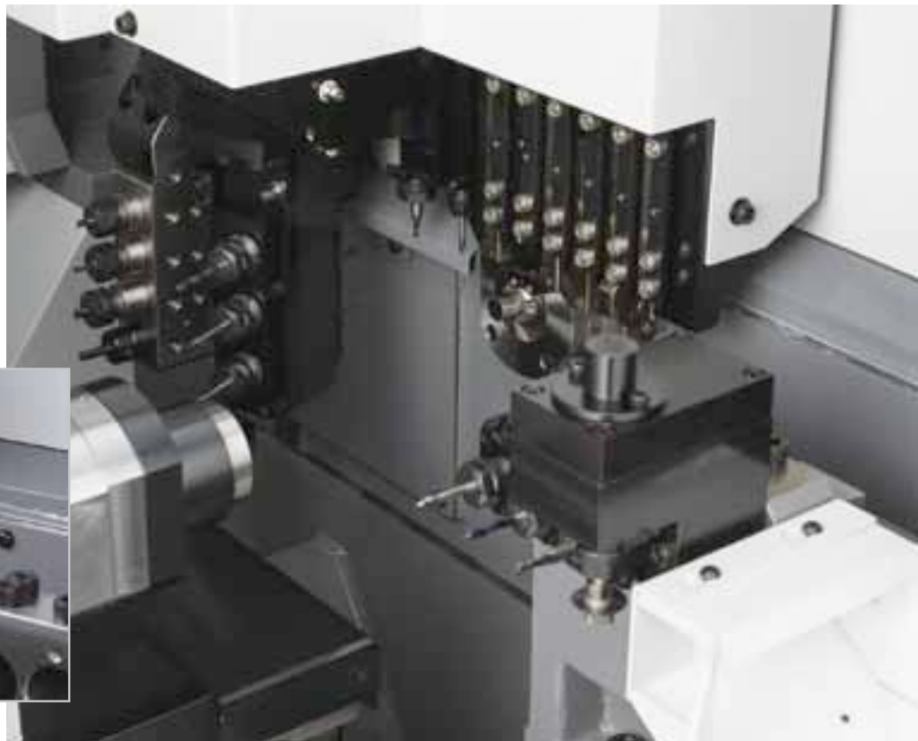
Auslegung mit Führungsbuchse (gezeigt mit angetriebenen Werkzeug für Rückseitenbearbeitung)
