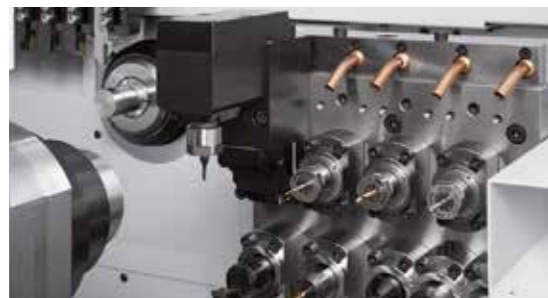
An Maschinen des Typs X und XII kann der Werkzeughalter für Rückseitenbearbeitung insgesamt 8 Werkzeuge aufnehmen: 4 angetriebene Werkzeuge in der oberen und 4 feststehende Werkzeuge in der unteren Reihe.
