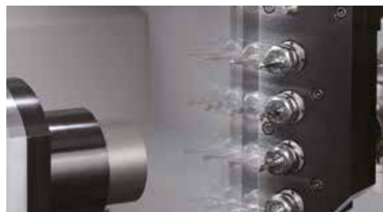
Maschinen des Typs XII sind serienmäßig mit einer B-Achse für angetriebene Werkzeuge an den Vertikalhaltern ausgestattet; die B-Achse kann innerhalb eines Bereichs von 135° [von 90° bis -45°] verstellt werden.
