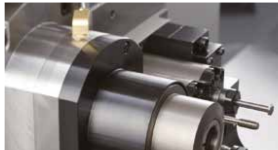
Was den Werkzeughalter für Vorderseitenbearbeitung betrifft, so kann wahlweise ein Werkzeughalter vorgesehen werden, der sich für die gleichzeitige Bearbeitung mit zwei Werkzeugen an der Führungsbuchse [schruppen/schlichten] eignet oder aber einer, in den Werkzeuge zum Tieflochbohren eingesetzt werden können.
