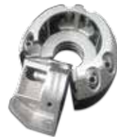
Blasform mit konturnaher Kühlung aus Maraging Stahl
