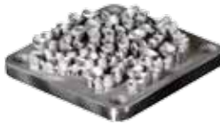
Fertigung von Teilkronen, Kronenkappen und Brücken aus Kobalt-Chrom (CoCr)
